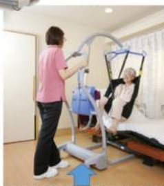
寝たきりで足で踏ん張れない方への床移動式リフトを導入予定!
