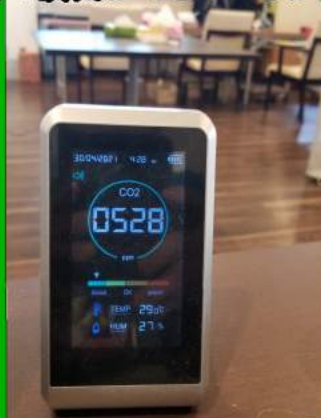
室内の換気ができているか、CO2モニターで管理
