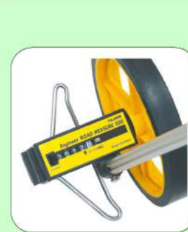
左・中：ロードメジャー。車輪の横に距離計が付いており、転がしながら距離を測る事が出来ます。 右：パルスオキシメーター。血中の酸素飽和度や脈拍を見る事が出来ます。
